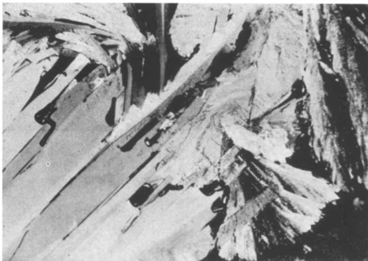
Cliché 1. La forme (I) en prismes et la forme (II) en sphérulites sont observées dans le champ du microscope entre nicols croisés
